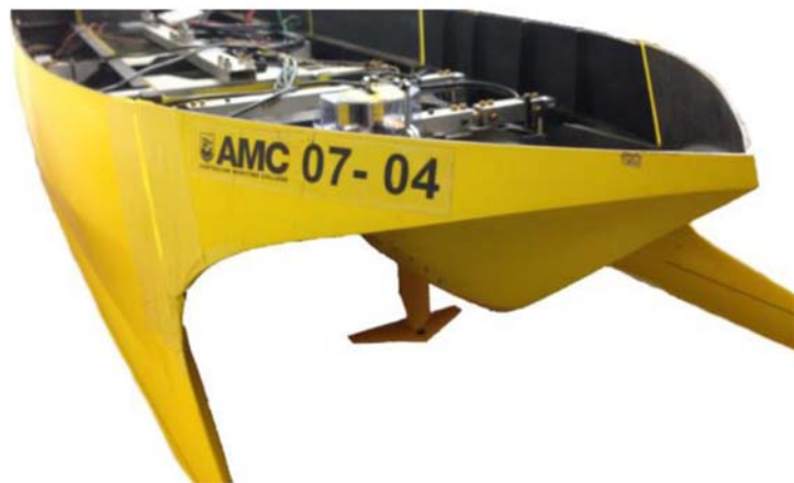
Figur 3.1 – 2.5m hydroelastisk model af 112m INCAT WPC monteret med RCS (Alavimehr, Lavroff, Davis, Holloway, & Thomas, 2017)
